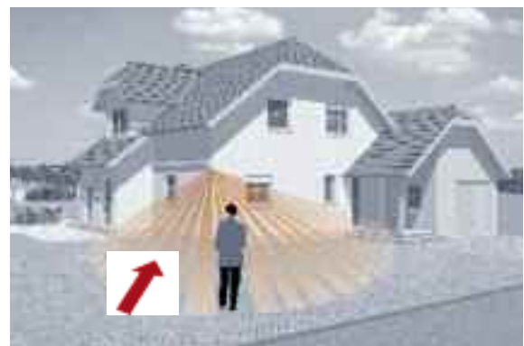
Радиално отчитане – движение директно към сензора (намалено отчитане към номиналния диапазон на действие)
