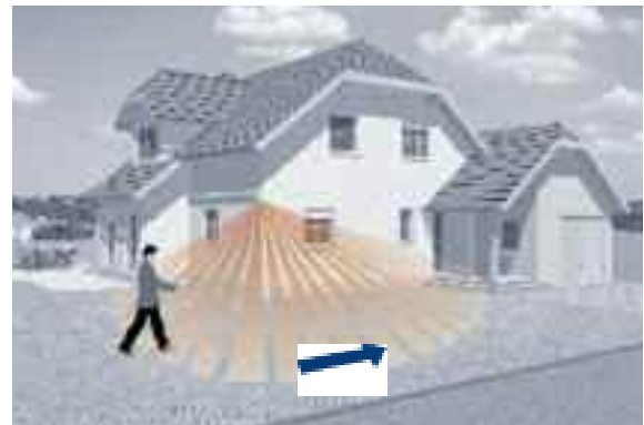
Тангенциално отчитане – движение напречно към сензора (номинален диапазон на действие)
